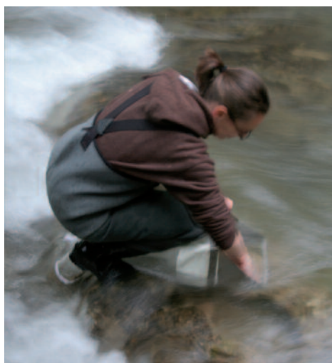
Prélèvement de faune au filet Surber afin d'évaluer la qualité de l'eau et du milieu (norme IBGN)
