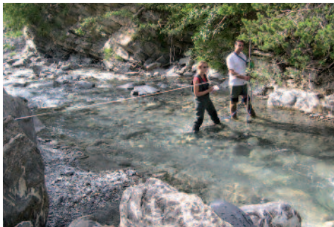
Jaugeage à l'aide d'un courantomètre
